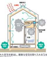
外れた空気を排出し、新鮮な空気を取り入れる「24時間換気システム」
