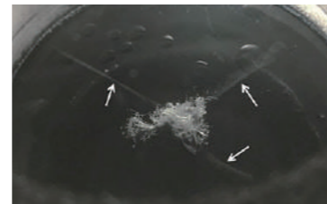
霧箱で見る放射線の通り道 ※霧箱とは放射線を測定するための装置です。霧箱を観察すると飛行機雲のように放射線が発生する様子を見ることができます。
