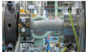
機械の中で180~200℃に熱する。水あめのように溶けたら円形状の隙間に圧力をかけて押し込み、パイプの形にする。
