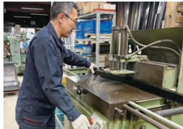
図面を基に正確な長さでアルミ型材を切断します。
