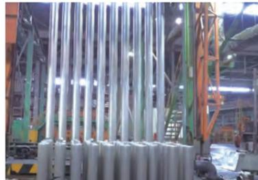
原料となるアルミを溶解・成形し、腐食に強くするための表面処理を行います。
