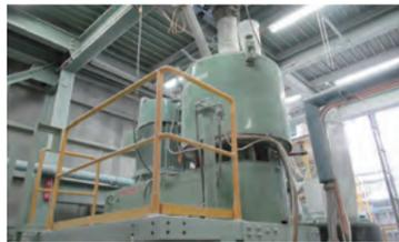
プラスチックのもととなる粉の状態の原料(塩化ビニル樹脂)に着色や固めるための薬を混ぜる。
